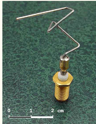
Figure 10: Antenne ST5 de la NASA, obtenue via algorithmes évolutionnaires; premier objet créé de cette manière à aller dans l'espace (2006).
